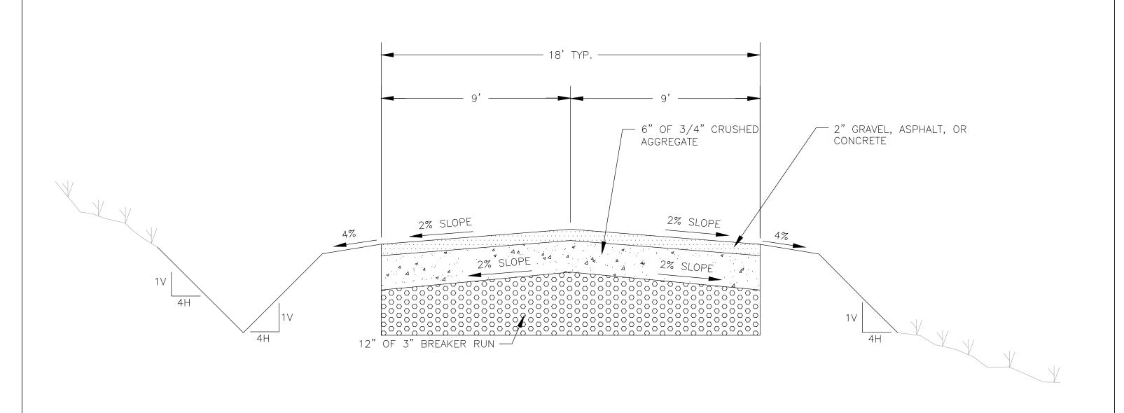
FIGURE 1 — GREATER THAN 200 FEET DRIVEWAYS TYPICAL CROSS SECTION
